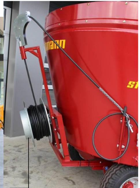
*Die Kabelrolle wird je nach Bedarf links, rechts oder hinten montiert.*
