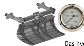
Das hydraulische Planierschild (Wahlausstattung) ist sowohl höhenverstellbar als auch drehbar; mit hydraulisch pneumatischer Dämpfung, seitliche Zusätze inklusive - Druckmesser dient zur Kontrolle des Anpressdrucks
