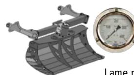
Lame niveleuse (option) avec extensions, réglable en hauteur et tournable, avec amortissement hydro-pneumatique. Manomètre pour contrôler la pression d'appui
