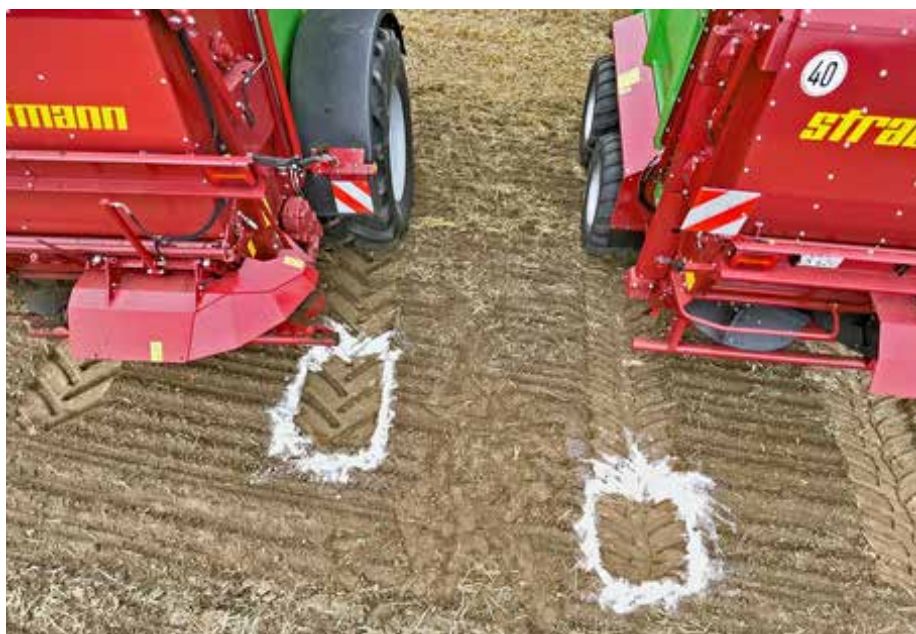
Die Aufstandsfläche der Reifen am TS 140 (links) ist größer als am VS 1805. Die Tandemachse verdoppelt aber über die Reifenanzahl ihre Aufstandsfläche. Die Einzelachse kurvt schonender.
