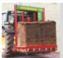
**1984** Avec la première désileuse en bloc U, l'Hydrofox HP, Strautmann présente au grand public une désileuse en bloc permettant la reprise de blocs absolument rectangulaires du silo-couloir.
