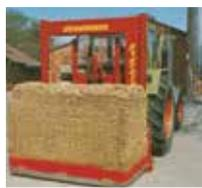
**1976** Mise en pratique de la première désileuse en bloc entièrement hydraulique Hydrofox F/H. Pour la première fois, aucun travail manuel n'est nécessaire.
