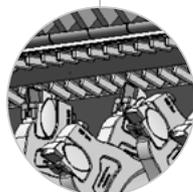
Rotor : marteaux fixes avec des inserts en carbure de tungstène et avec un support d'marteaux anti-usure; 2 rangées de contre-couteaux estampés pour un travail parfait.
