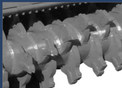
Les rotors de cette série sont dotés d'outils fixes parfaitement adaptés pour broyer du bois, fraiser des souches, broyer des pierres et pour travailler le terrain.
