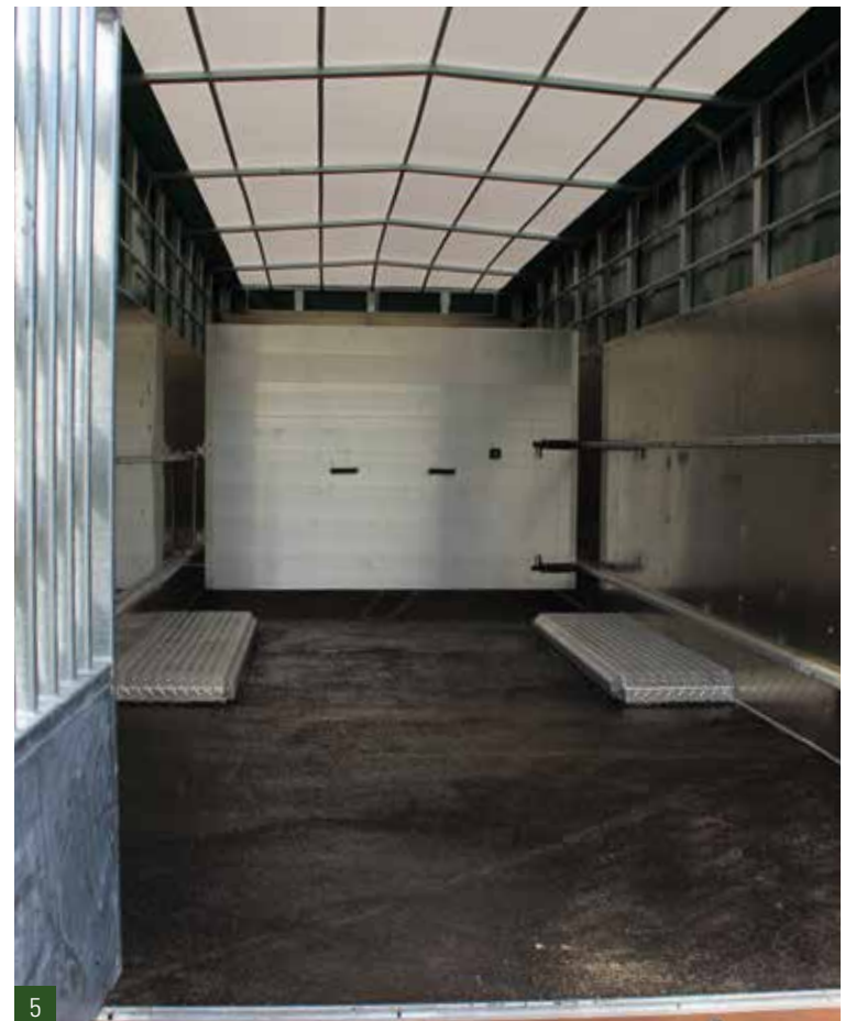
5. Trennwand aus Aluminium inkl. Lochschiene, sowie Plane inkl. Lichtband
