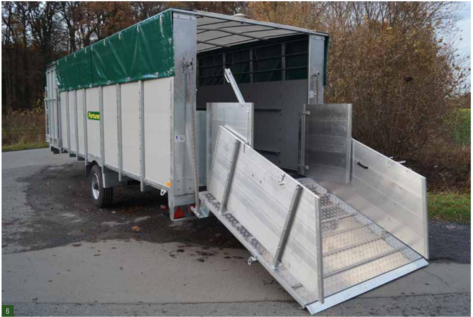
6. Aufbaufarbe mit Aluminiumtränenblech inkl. Aufkantungen, Treibwänden aus Aluminium und eine Endwand aus Aluminium als Flügeltür
