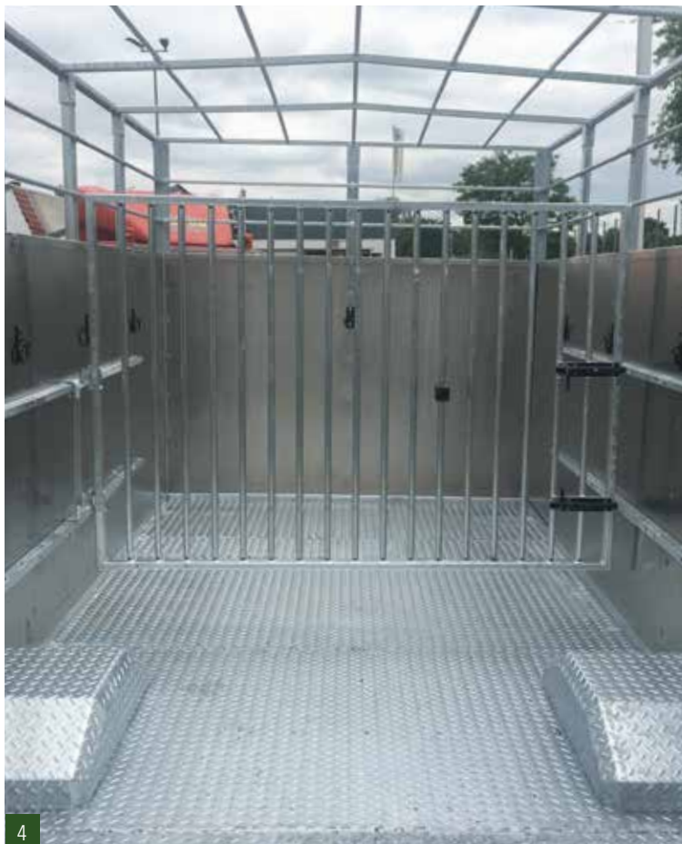
4. Trenngitter aus Stahl (verzinkt) inkl. Lochschiene, Anbinderinge, sowie Spriegelaufbau ohne Plane
