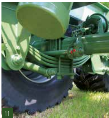
11. Federn unter den Achsen, für 32 t Parabelfederung mit Längslenkern
