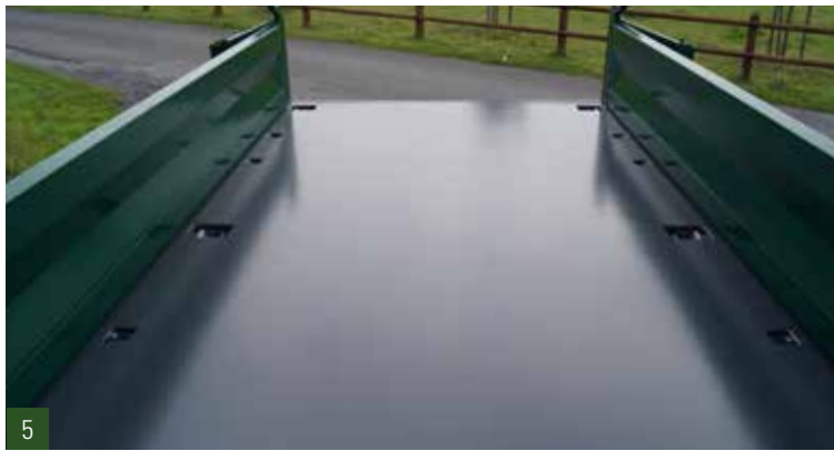
5. eingelassene Zurringe (nach UVV) mit einer Zurrkraft je Stück von 2.500 daN oder 10.000 daN
