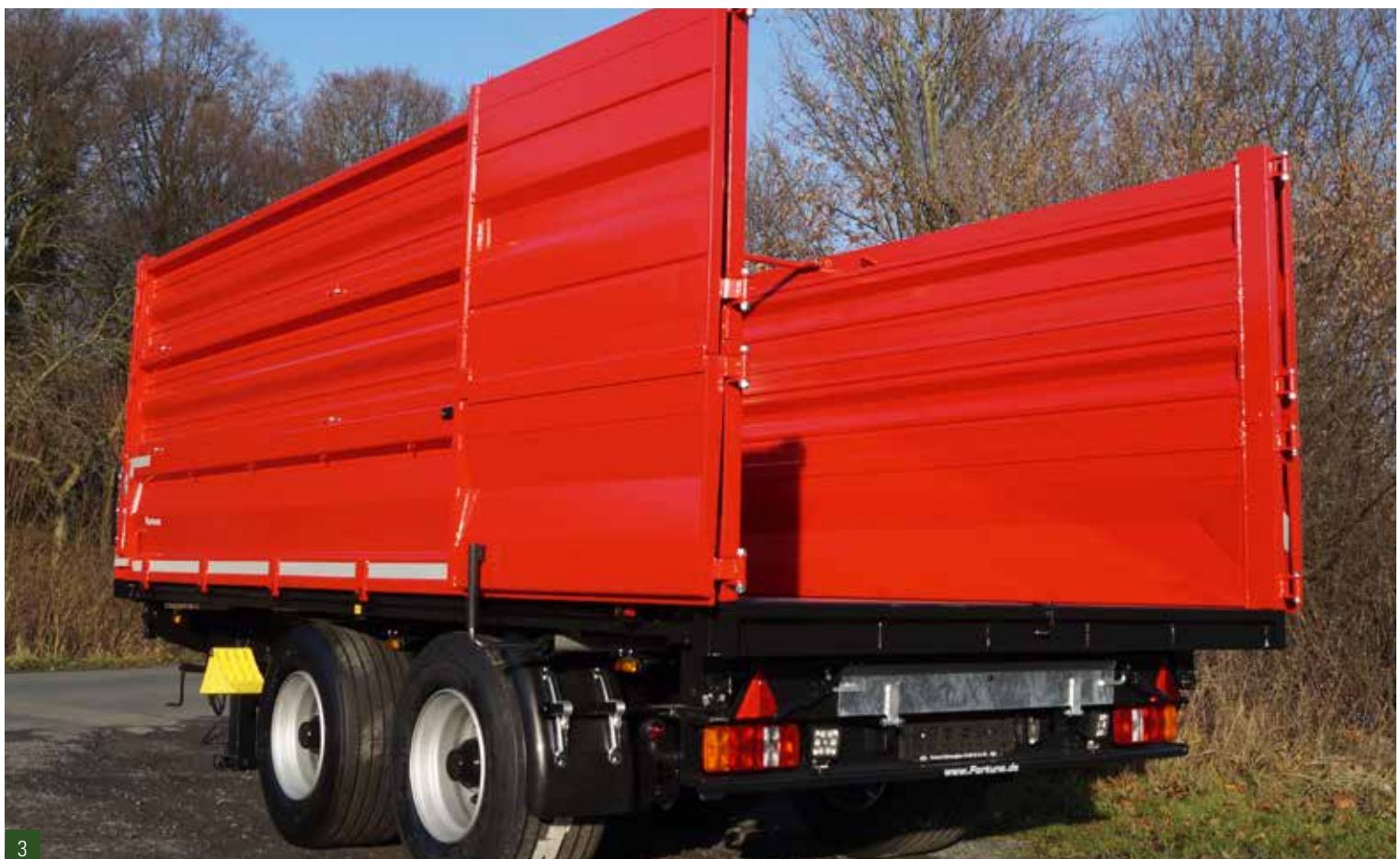
3. Bordwand 600 mm hoch aus Hardox, zusätzliche Stahlpendelaufsatzwände 600 mm und 600 mm, inkl. zweiflügeliger Hecktür
