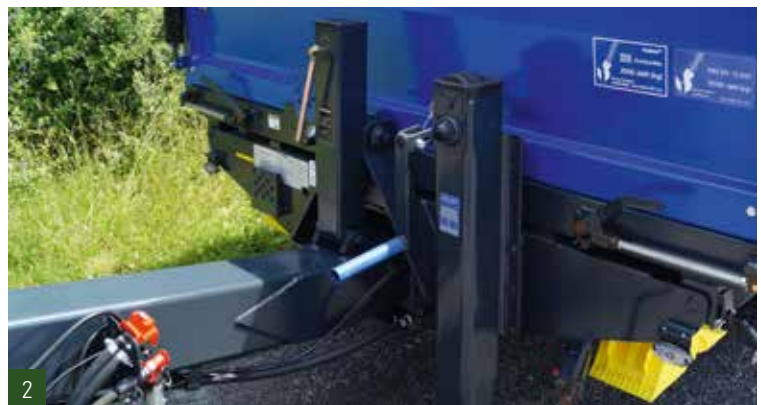
2. Zugdeichsel durch Getriebewinde von 650 - 1050 mm höhenverstellbar
