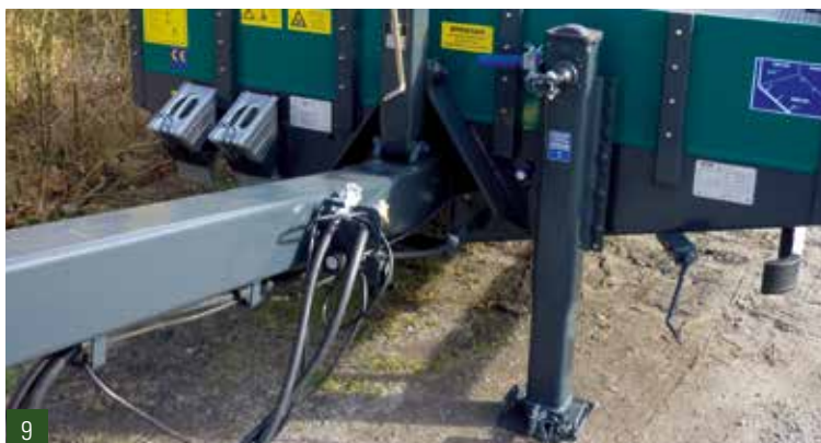
9. 10 t Jost® Stützwinde mit Last- und Schnellgang, Fußplatte teleskopierbar
