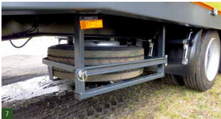
7. Reserveradhalter in Korbform unter dem Fahrgestell
