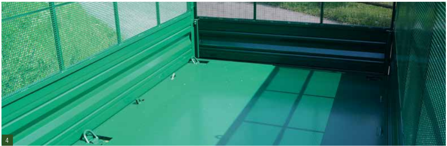
4. Laubgitteraufbau als Lochgitter / Zurringe in den Boden einschwenkbar nach UVV, Zurrkraft 4000 daN
