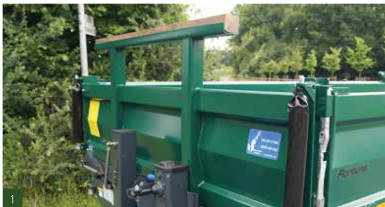
1. Stirnwandablagebock z.B. für Baggerschaufeln
