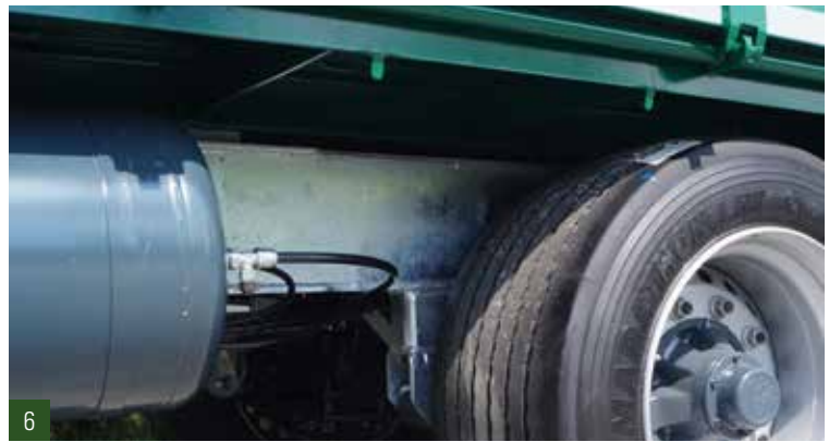
6. Fahrgestell in verzinkter Ausführung, Netzhaken (innen) am Außenrahmen der Kippbrücke angebracht
