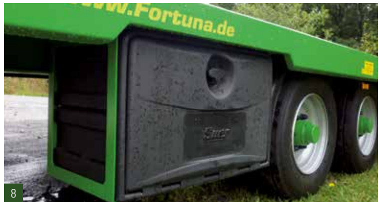
8. abschließbarer Werkzeugkasten mit Drehriegelverschluss und inkl. Stahlrahmen
