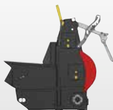
Déflecteur automatique Position de chargement de botte
