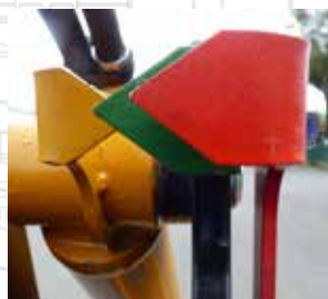
Repère de niveau et repère de position du rotor
