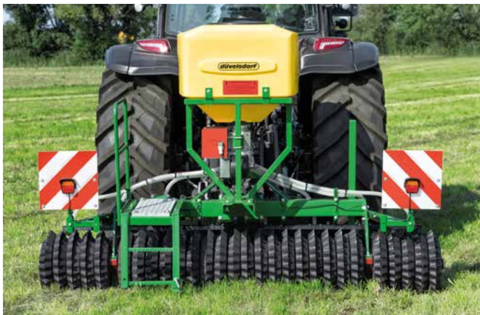
TERRA.ROLLER eco avec dispositif de semis
