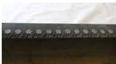
Bande de caoutchouc avec garniture en acier
