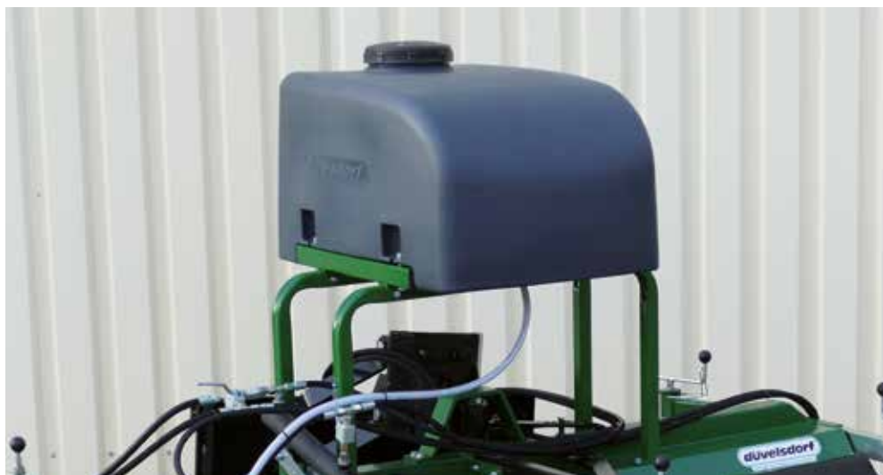
Pulvérisateur avec réservoir d'eau de 200 litres
