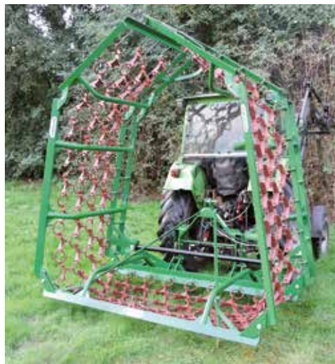
Herse pour herbages 8,00 m, 4 rangées, pliable hydrauliquement
