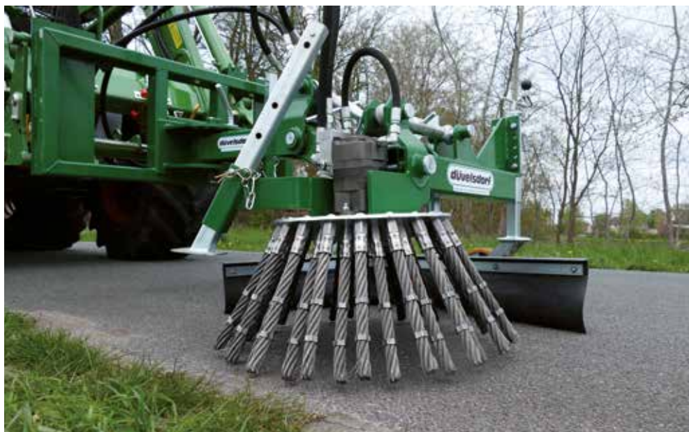
Balai à mauvaises herbes avec poils en acier
